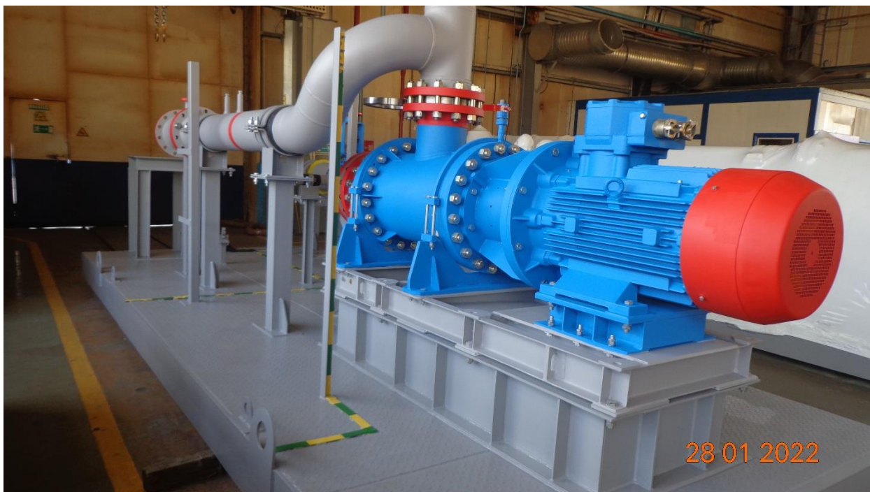
Сизготовление насосной пожаротушения СНП-400
