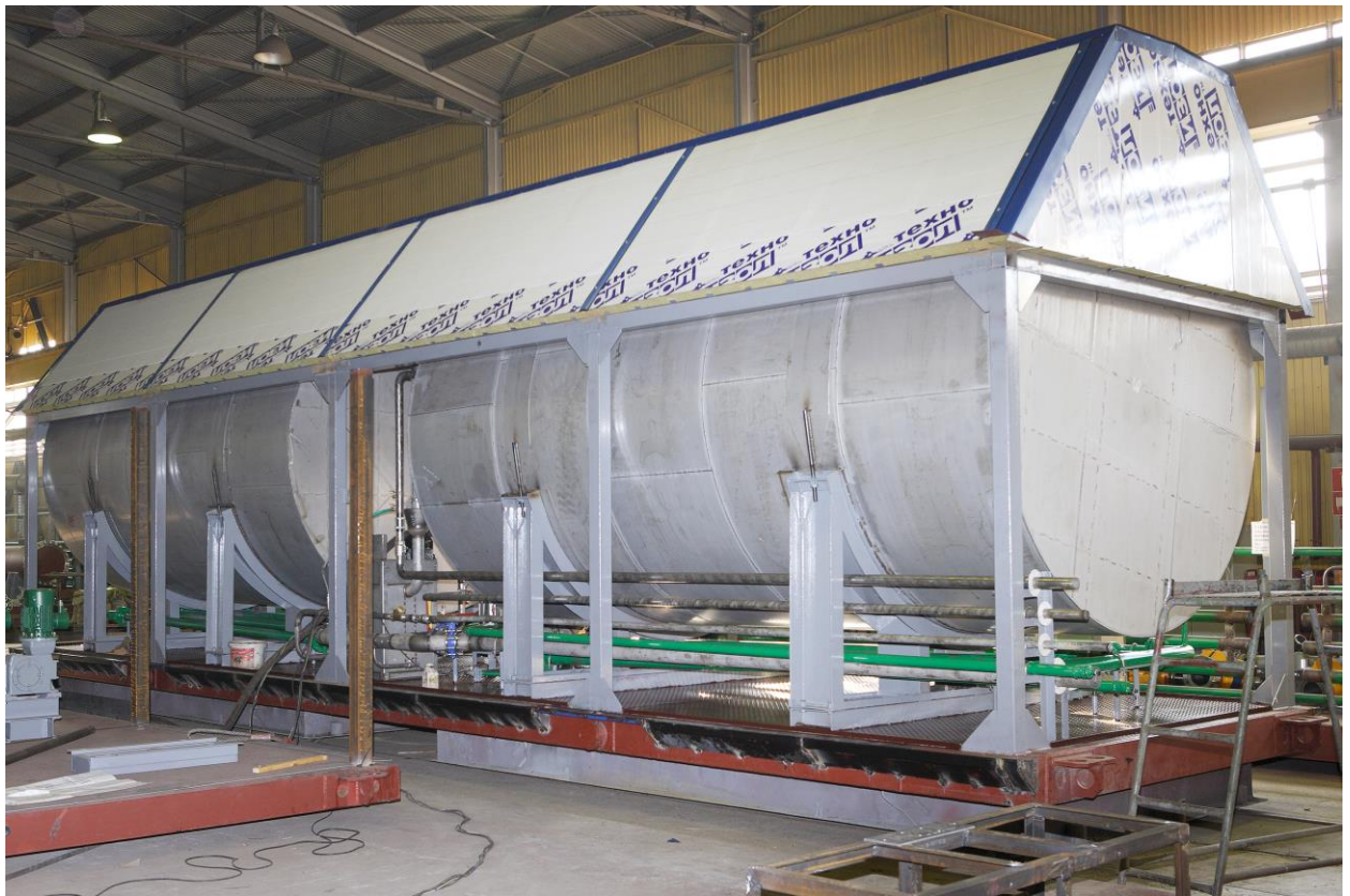
Изготовление подстанции водонапорной «ПВ-60» на Тюменском экспериментальном заводе.
