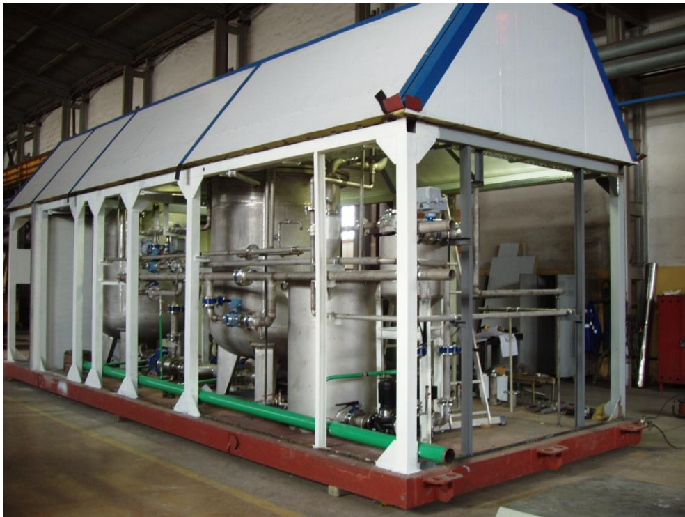
Сборка станции «СДПВ-500» на Тюменском экспериментальном заводе.
