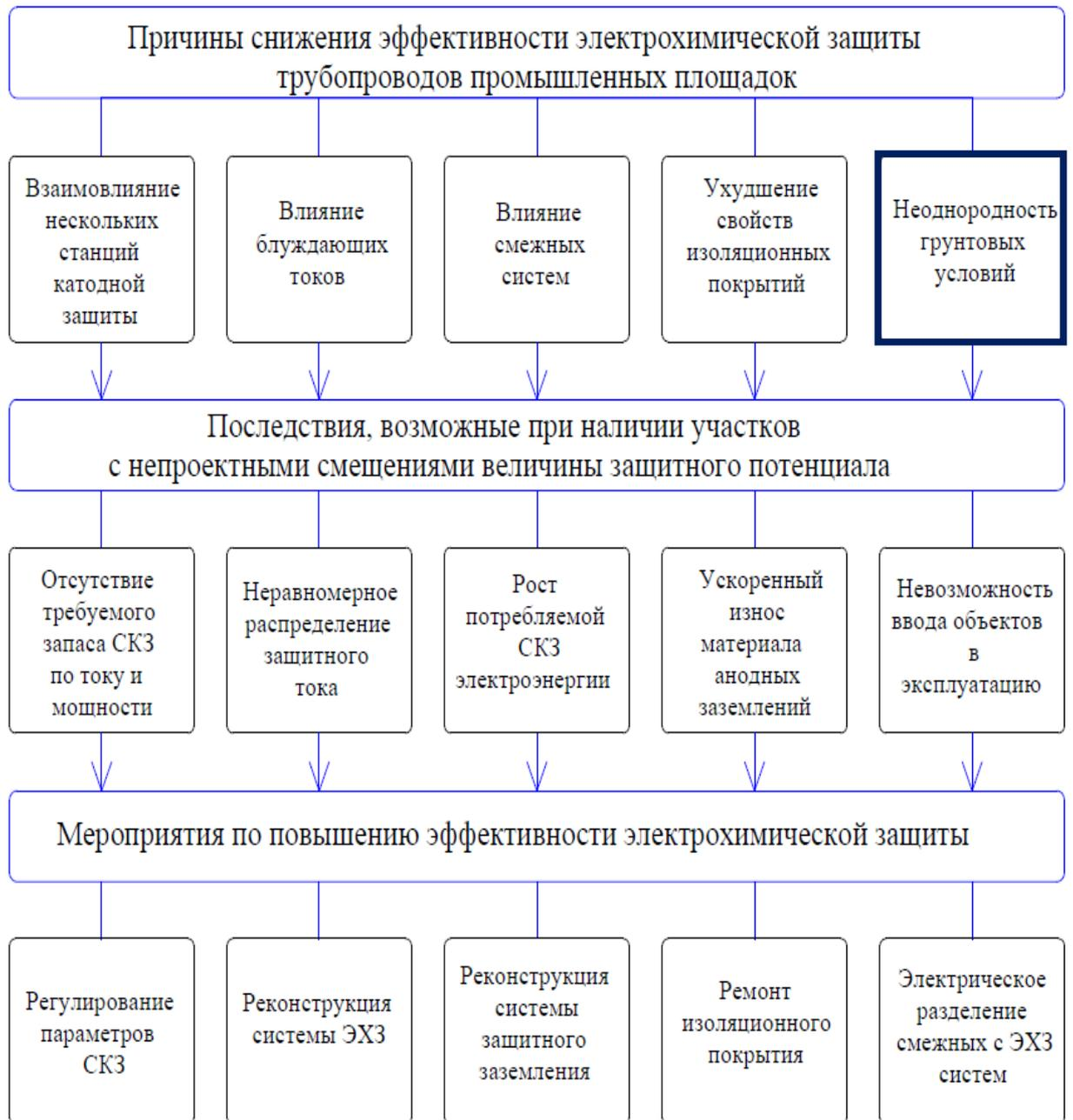
Рисунок 1.2 – Классификация причин и возможных решений проблемы защищенности участков трубопроводов от коррозии
