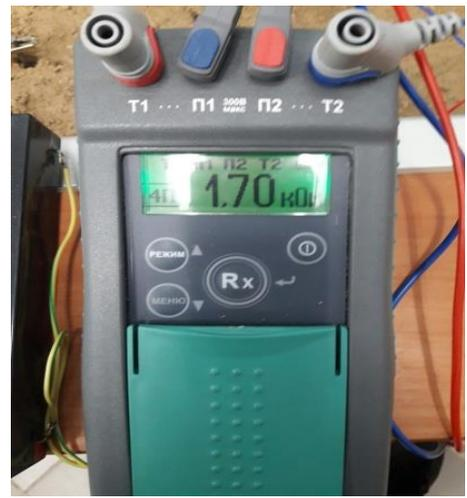
Рисунок 3.3 – Измеритель сопротивления ИС-10
