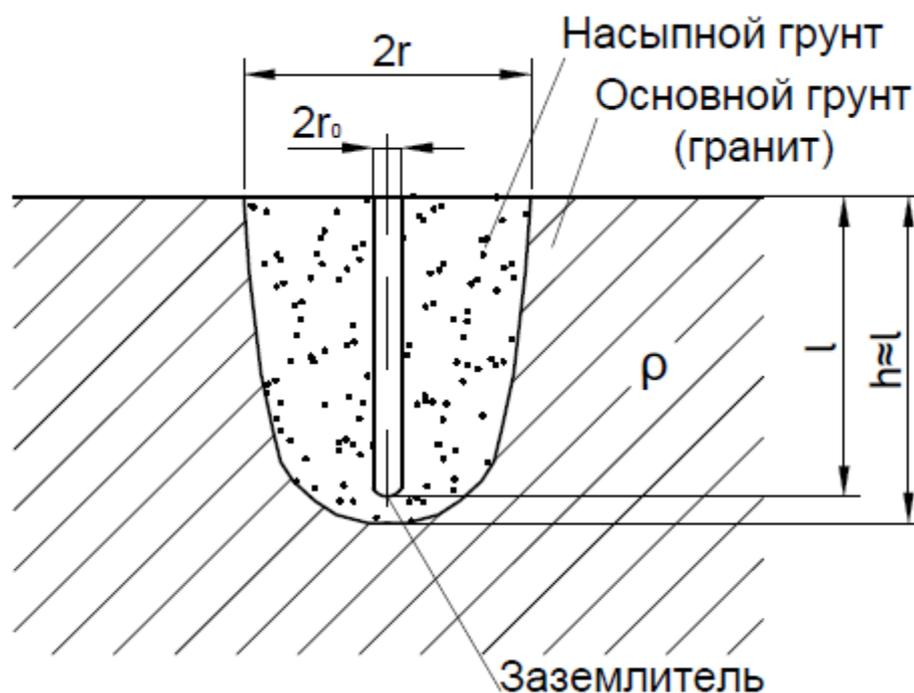
Рисунок 1.6 – Создание вокруг заземлителя зоны с пониженным удельным сопротивлением
