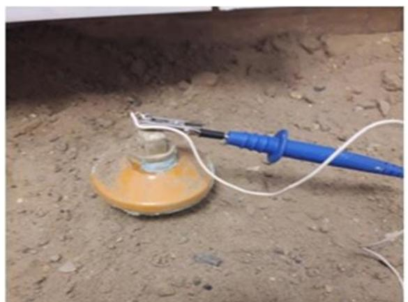
Рисунок 3.5 – Медносульфатный электрод сравнения
