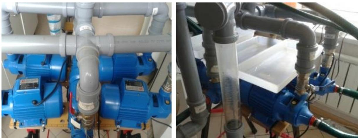
Рисунок 12 - Фотография(и) установки для исследования электрохимических свойств стали в движущихся средах (трубы и стыки)
