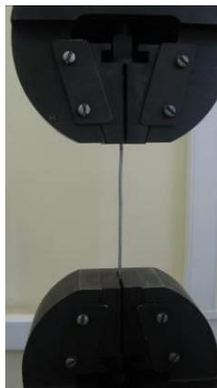
Рисунок 19 - Разрывная машина ИР 5047-50 с установленным для калибровки стержнем (рабочим электродом)
