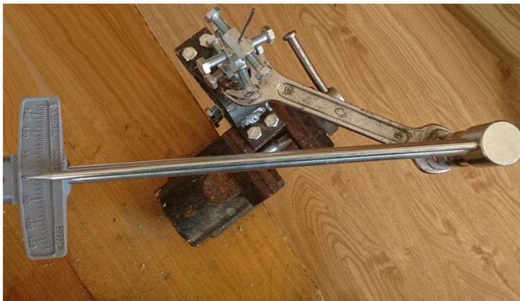
Рисунок 23 - Фотография ячейки при установке необходимой нагрузки на рабочий электрод.
