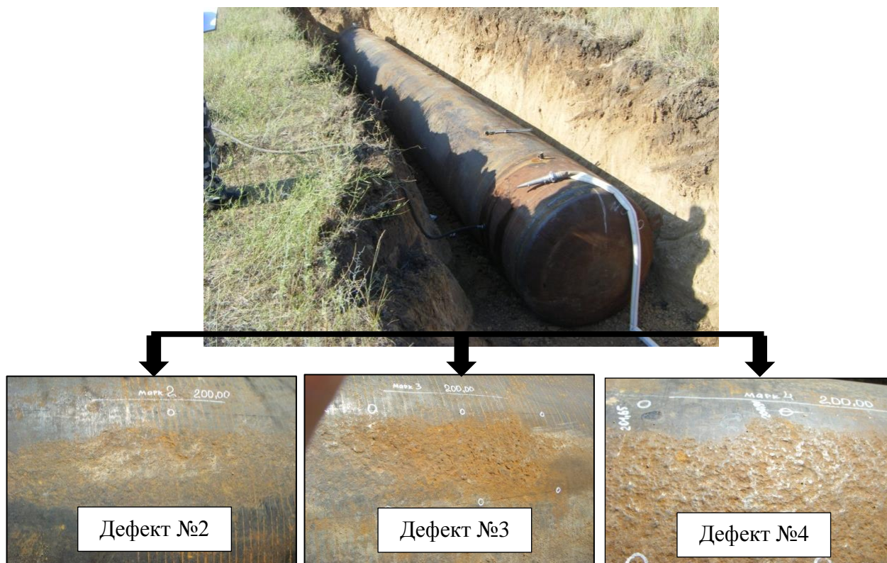
Рисунок 7 – Общий вид плети и содержащихся на ней дефектов
