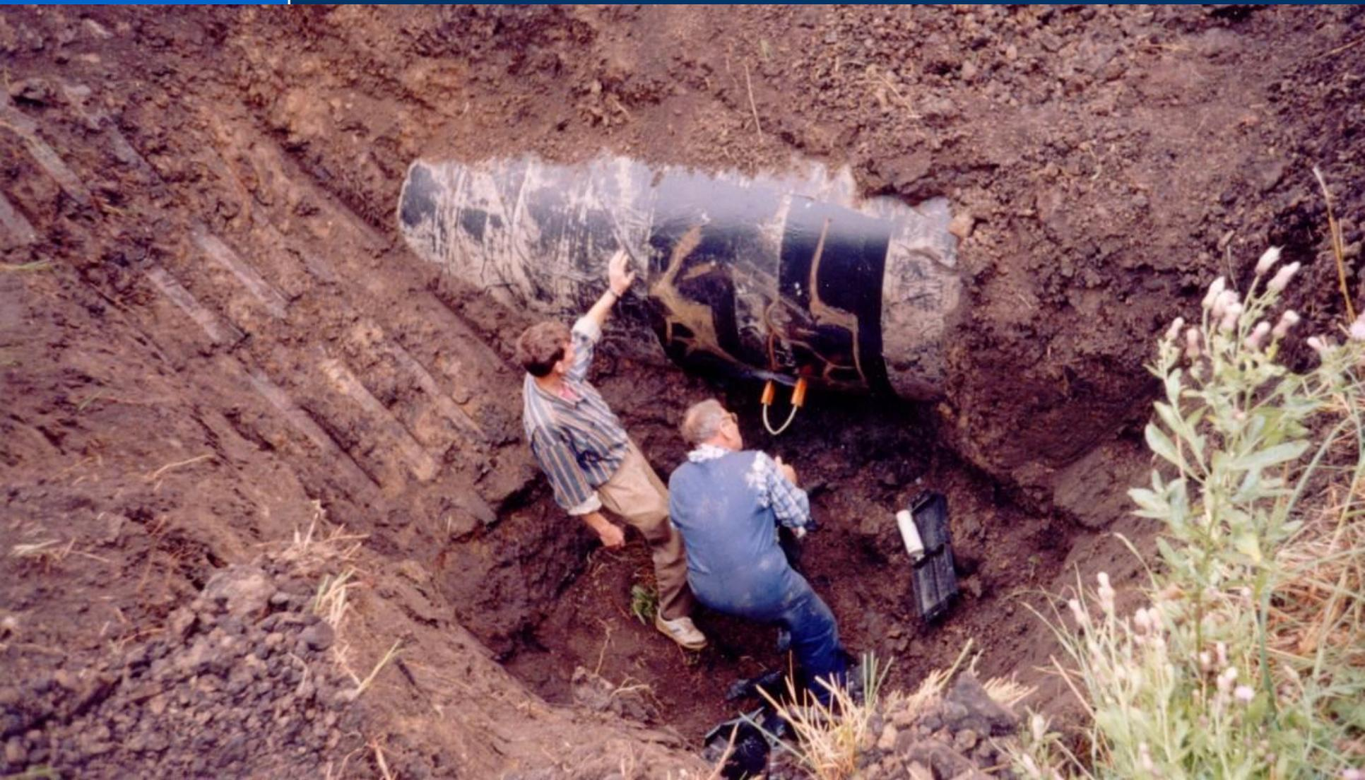
Для исследования стресс-коррозионных повреждений в процессе нагружения труб внутренним давлением в Краснотурьинском ЛПУМГ ООО «Тюментрансгаз», в Полянском ЛПУМГ ООО «Баштрансгаз» и в Серпуховском УМГ ООО «Мострансгаз» были созданы трубопроводные стенды. В ходе исследований решались следующие важные задачи:
