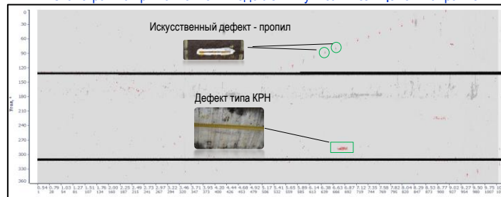
Сканограмма при наклонном вводе УЗ-импульса в продольном направлении
