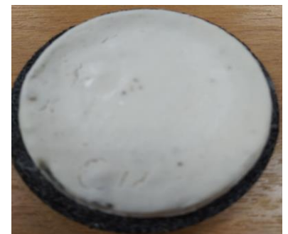
Рисунок 3.104 – Субстрат с фильтром проницаемостью 54 мД при перепаде давления 0,69 МПа и температуре 74°C
