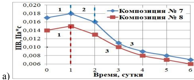
Рисунок 3.60 – Реологические параметры полимерных композиций № 7, 8 (таблица 3.1)
