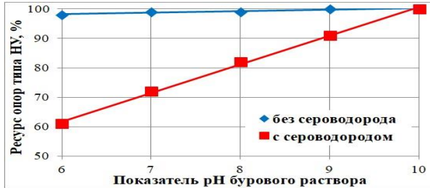
Рисунок 3.113 – Зависимость ресурса опоры типа НУ от pH бурового раствора при отсутствии и наличии H 2 S
