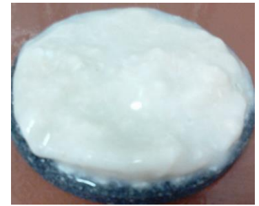
Рисунок 3.102 – Субстрат с фильтром проницаемостью 76 мД при перепаде давления 0,69 МПа и температуре 74°C
