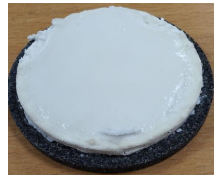
Рисунок 3.108 – Субстрат с фильтром проницаемостью 367 мД при перепаде давления 2,76 МПа и температуре 74°C
