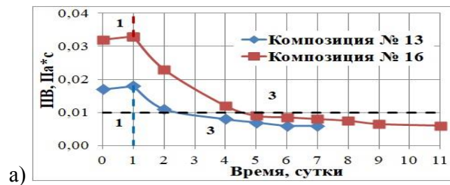
Рисунок 3.62 – Реологические параметры полимерных композиций № 13, 16 (таблица 3.3)
