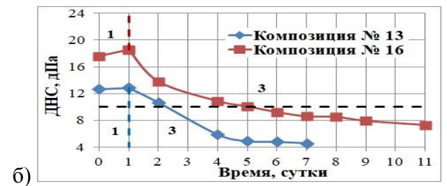
Рисунок 3.62 – Реологические параметры полимерных композиций № 13, 16 (таблица 3.3)
