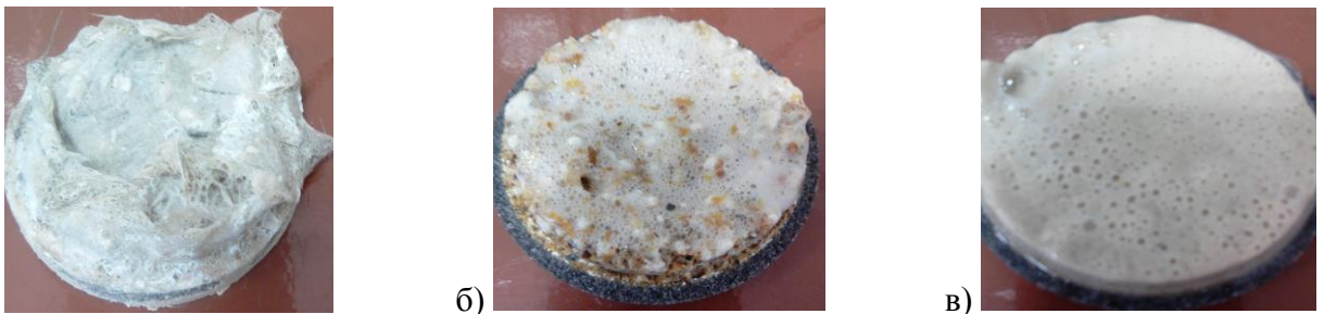
Рисунок 3.131 – Субстрат кольматирующей смеси на керамических фильтрах проницаемостью 54 мД при T = 74^{\circ}\text{C} и \Delta P = 2,07 \text{ МПа} : а) с МК и фиброй, б) с Kwik-Seal, в) с EZ-Plug
