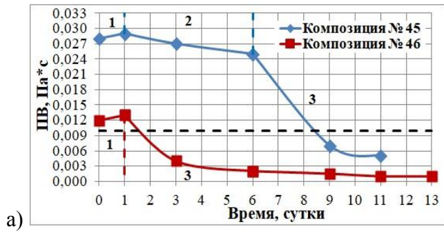
Рисунок 3.73 – Реологические параметры полимерных композиций № 45, 46 (таблица 3.7)
