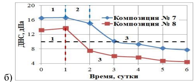
Рисунок 3.60 – Реологические параметры полимерных композиций № 7, 8 (таблица 3.1)
