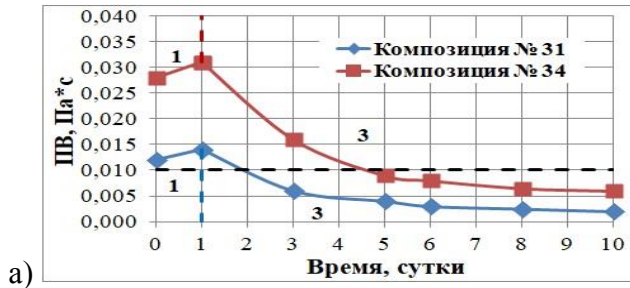
Рисунок 3.68 – Реологические параметры полимерных композиций № 31, 34 (таблица 3.6)
