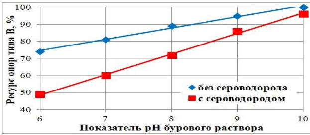
Рисунок 3.111 – Зависимость ресурса опоры типа В от pH бурового раствора при отсутствии и наличии H 2 S
