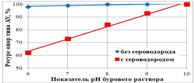
Рисунок 3.114 – Зависимость ресурса опоры типа АУ от pH бурового раствора при отсутствии и наличии H 2 S
