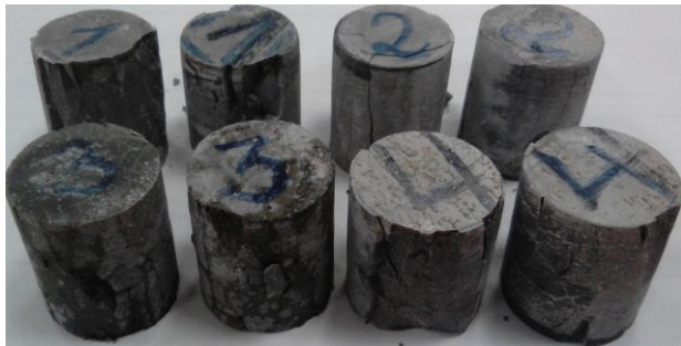
Рисунок 5.24 – Экспериментальные образцы, насыщенные NaCl, после оценки прочности на сжатие
