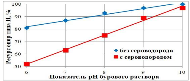
Рисунок 3.112 – Зависимость ресурса опоры типа Н от pH бурового раствора при отсутствии и наличии H 2 S
