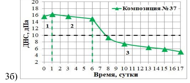
Рисунок 3.70 – Реологические параметры полимерных композиций № 35-37 (таблица 3.6)
