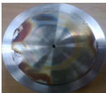
Рисунок 3.17 б – Коррозия ячейки (композиция № 32 с бактерицидом и NaOH)
