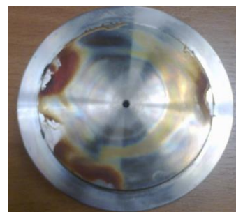
Рисунок 3.17 а – Коррозия ячейки (композиция № 32 с бактерицидом и NaOH)
