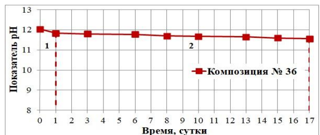
Рисунок 3.47 б – Диаграмма «старения» композиции № 36 от времени при 100°C
