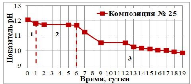
Рисунок 3.41 б – Диаграмма «старения» композиции № 25 от времени при 20°C
