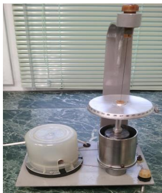
Рисунок 2.4 – Прибор СНС-2 для определения адгезионных свойств технологических жидкостей
