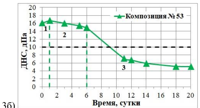
Рисунок 3.75 – Реологические параметры полимерных композиций № 51-53 (таблица 3.7)
