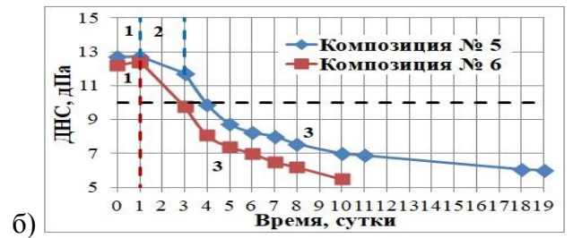
Рисунок 3.59 – Реологические параметры полимерных композиций № 5, 6 (таблица 3.1)
