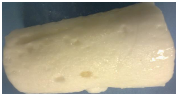
Рисунок 3.19 а – Гелеобразование композиции № 38 при 20°C в покое
