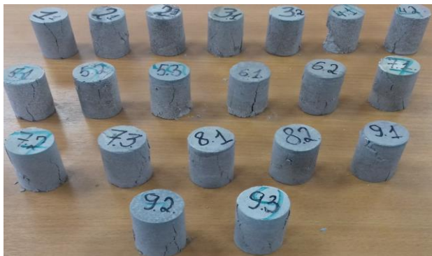
Рисунок 5.34 – Экспериментальные образцы, насыщенные NaCl, после испытания на прочность
