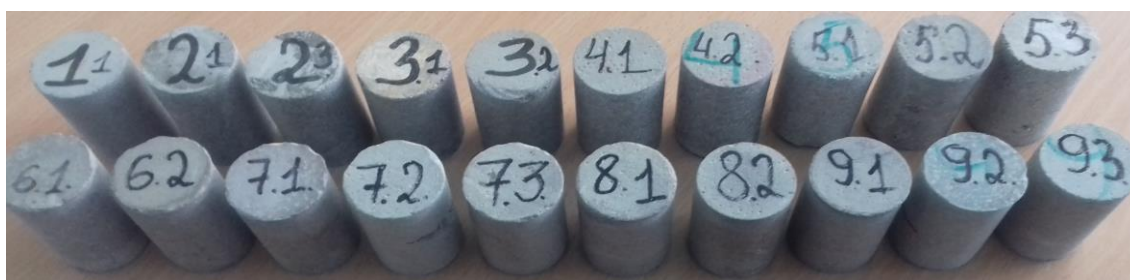
Рисунок 2.9 – Высверленные экспериментальные образцы
