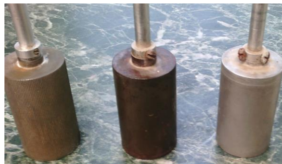
Рисунок 2.5 – Внутренние цилиндры СНС-2 с различными поверхностями (слева-направо: стальной гофрированный, стальной гладкий, алюминиевый гладкий)
