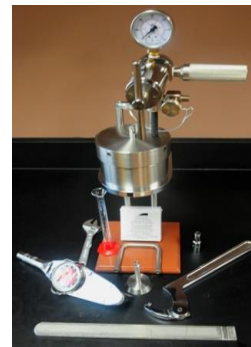
Рисунок 2.3 – Прибор для испытания на прихват Sticking Tester (США)
