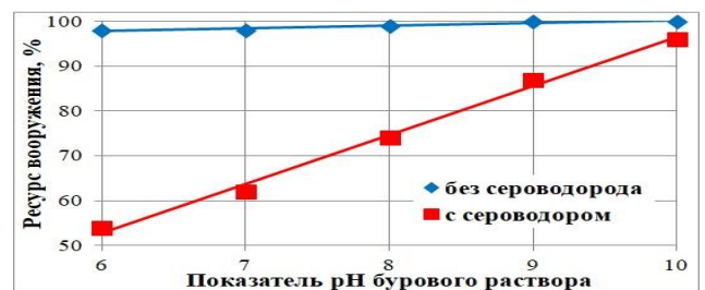
Рисунок 3.110 – Зависимость ресурса твердосплавного вооружения от pH бурового раствора при отсутствии и наличии H_2S
