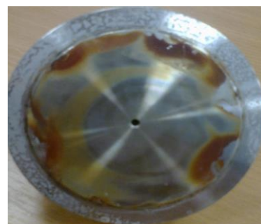
Рисунок 3.22 а – Коррозия ячейки (композиция № 45 с бактерицидом и NaOH)
