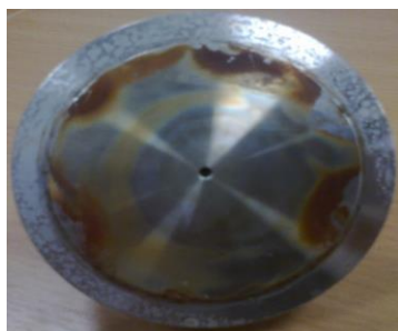
Рисунок 3.24 а – Коррозия ячейки (композиция № 48 с бактерицидом и NaOH)
