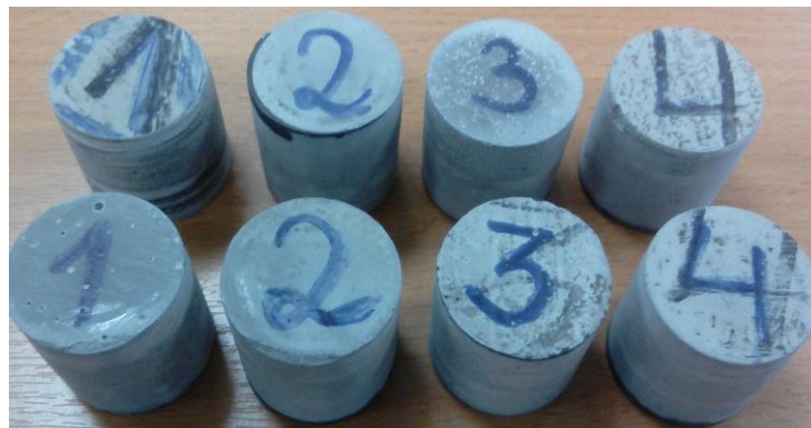
Рисунок 5.19 – Высверленные образцы для экспериментов
