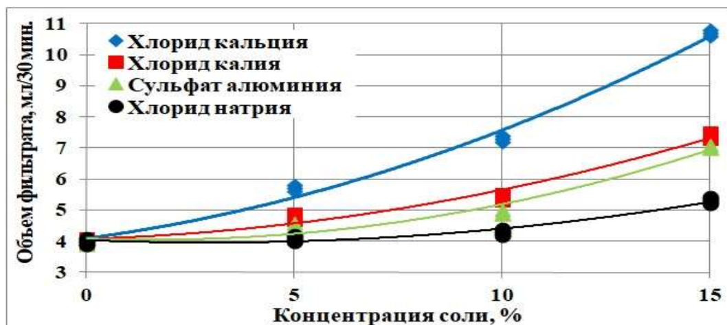
Рисунок 10 – Зависимости объема фильтрата буферных жидкостей за 30 минут от типа и концентрации соли (Optima)
