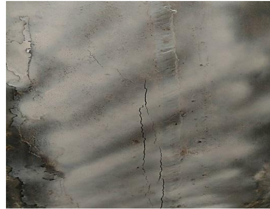
Дефекты КРН на магистральных газопроводах
