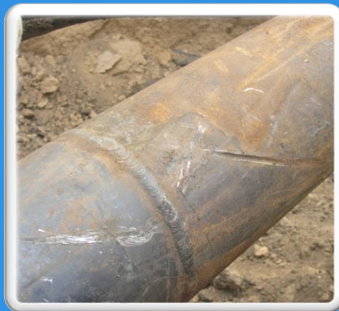
Механическое повреждение. Шлейф 168X12 скв 12014 УКПГ - 12.
