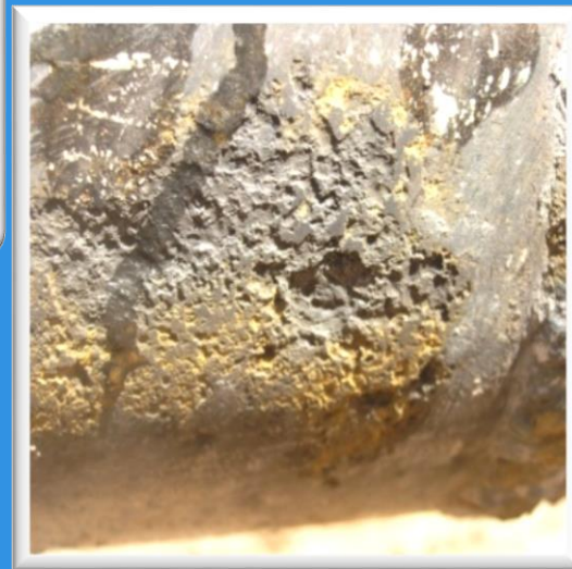
Механическое повреждение. Шлейф 168X12 скв 12014 УКПГ - 12.
