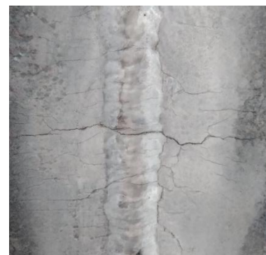
Кольцевое сварное соединение №39 (трещина глубиной до 12 мм)
