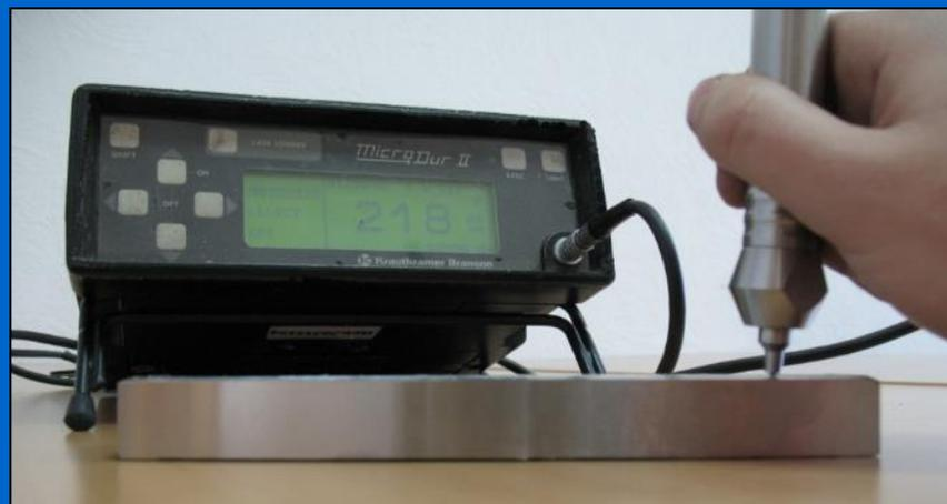
**Определение твердости металла**
