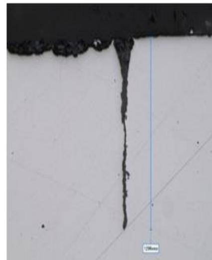
а) форма трещины КРН, не приводящая к существенной погрешности при оценке глубины дефекта КРН приборами НК (не более 30 %)
