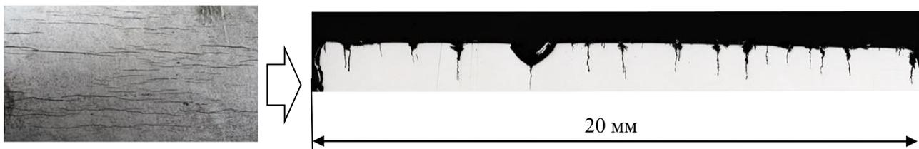
а) зона повреждения КРН с высокой плотностью трещин (более 4 ед. см<sup>2</sup>) - погрешность при оценке глубины трещины до 50 % при контроле с применением ВТП D < 5 мм и до 65% с ВТП D > 10 мм; до 40 % для электропотенциальных трещиномеров.
