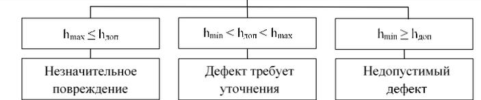
**Этап 3.** Проведение МИК локализованного дефектного участка  $200 \times 200 \text{ mm}$  и идентификация дефекта на соответствие признакам КРН. Проведение ВИК и определение параметров дефекта КРН.
