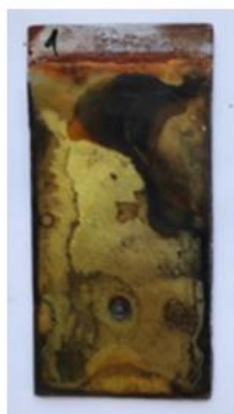
е) 70 сутки (после цикла заморозки/разморозки)
