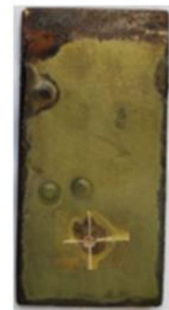
е) 90 сутки (после процедуры контроля адгезии), диаметр отслоения 0,6 см
