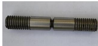
Образец с кольцевым надрезом для испытаний по методу SSRT
