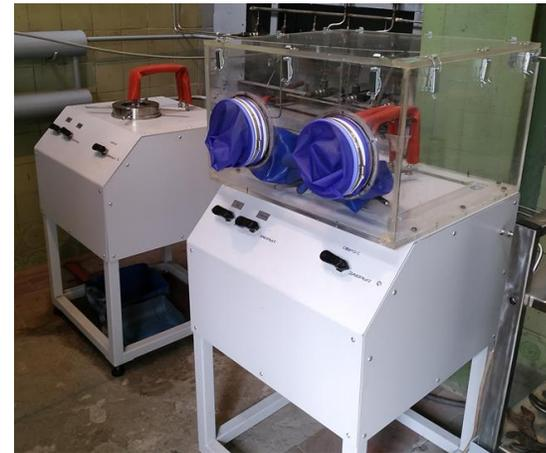
**Испытания металла труб МГ на трещиностойкость по ASTM E1681-03(2020) на образцах “СТ” с нагружением болтом в перчаточном ящике и последующей выдержкой в автоклаве в 100% H<sub>2</sub> в течение 1000 ч**
