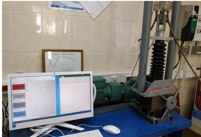
**Испытания на растяжение по методу SSRT на стенде КРН с предварительным наводороживанием образцов в автоклаве**
