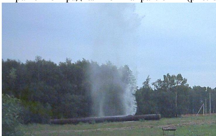
Рисунок 8 — Разрыв плети трубопровода при проведении экспериментальной опрессовки.
