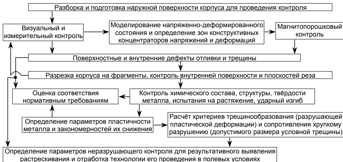
Рисунок 4 – Алгоритм метода лабораторного неразрушающего и разрушающего контроля выбранных элементов ФА
