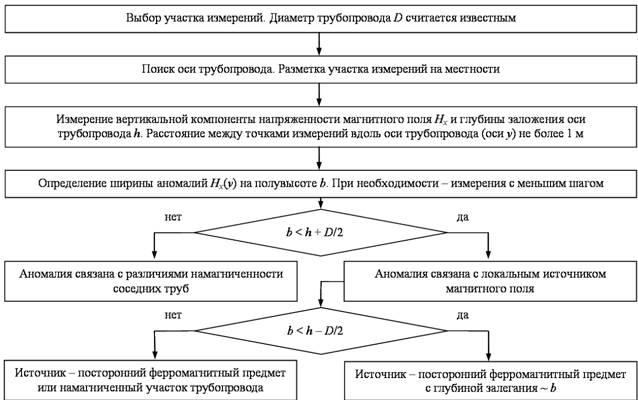
Рисунок 15 – Алгоритм реализации метода поиска посторонних ферромагнитных предметов
