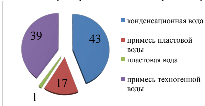
Рисунок 11. Соотношение конденсационной, техногенной и пластовой жидкостей в отобранных пробах из скважин Бованенковского НГКМ.
