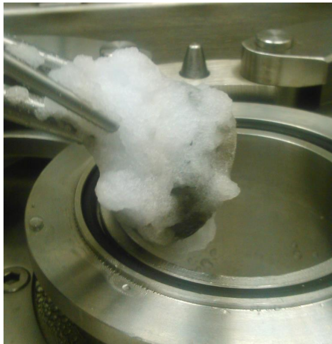
Рисунок 2.19 – Фотография газового гидрата на перемешивающем устройстве в растворе этиленгликоля по окончании эксперимента
