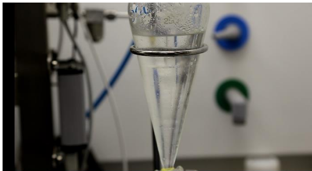
Рисунок 6 – Ачимовский конденсат + ингибитор на основе хлоридов магния и кальция разбавленный в 3 раза по окончании эксперимента (начальный момент времени зафиксировать не удалось)
