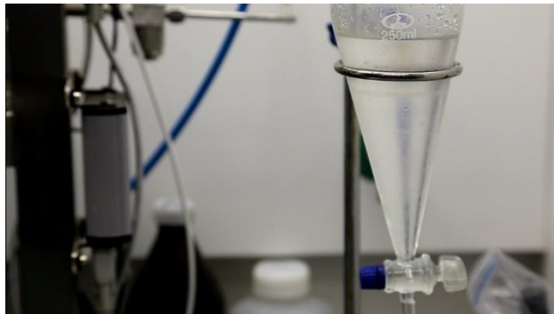
Рисунок 21 – Ачимовский конденсат + ингибитор этиленгликоль, разбавленный в 2 раза по окончании эксперимента (начальный момент времени зафиксировать не удалось)
