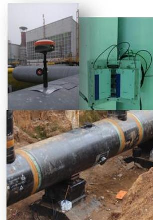
Контроль перемещений контрольных точек фундаментов, зданий, технологического оборудования и трубопроводов КС. Погрешность измерений – 3 мм.
