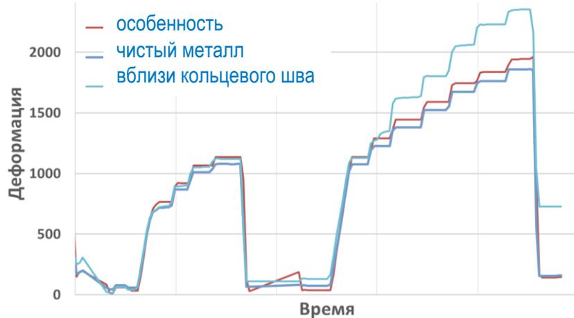
Данные тензодатчиков статических испытаний
