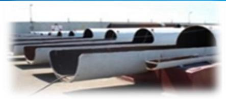
Экспериментальный стенд для испытаний кольцеобразных образцов труб с дефектами КРН
