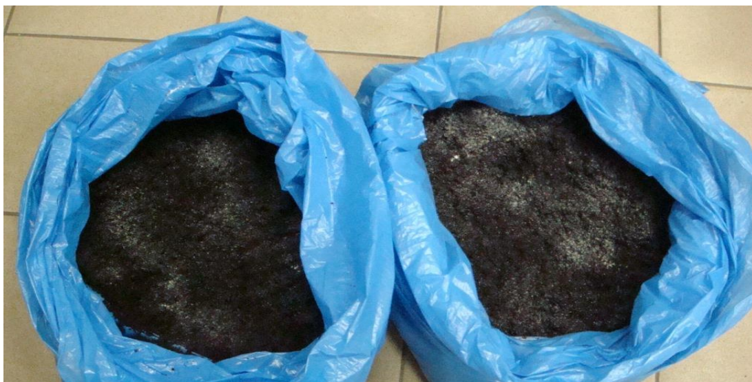
Рисунок 2.8 – Опытная партия биосорбентов с дрожжевой и бактериальной культурами
