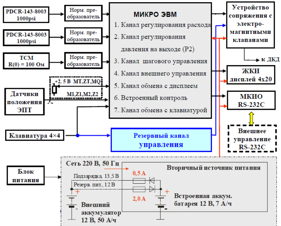
Рисунок 4.14 – Структура цифрового регулятора в системе управления ДКД [59]
