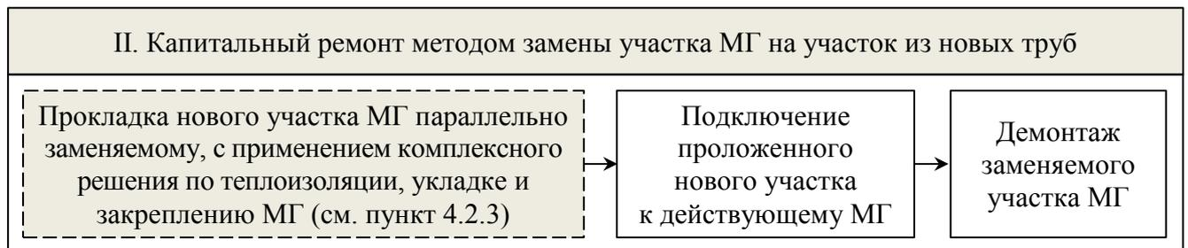
Рисунок 4.9 – Интеграция комплексного решения по монтажу трубной теплоизоляции, укладке и закреплению газопровода в структуру капитального ремонта методом замены участка МГ на участок из новых труб
