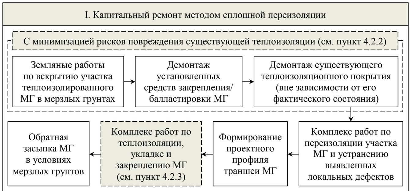
Рисунок 4.8 – Интеграция мероприятий по сохранению и восстановлению трубной теплоизоляции в структуру капитального ремонта методом сплошной переизоляции участка МГ
