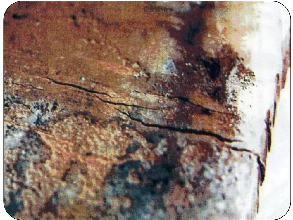
Наибольшее количество выявляемых при предремонтном диагностическом обследовании стресс-коррозионных повреждений имеют глубину до 10% от толщины стенки трубы.
