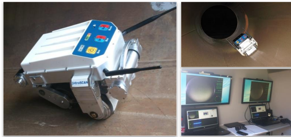
Внутритрубный ультразвуковой сканер-дефектоскоп A 2072 «IntroScan» (ЗАО «ИнтроСкан Технолоджи» г. Чайковский)
