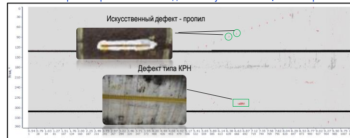
Сканогрмма при наклонном вводе УЗ-импульса в продольном направлении
