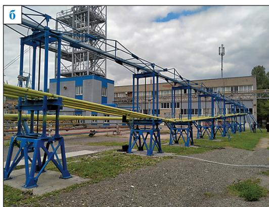
**Рис. 2. Экспериментальный комплекс для отработки технологий эксплуатации промысловых систем добычи и сбора газа: а – стенд для исследования ГЖП в скважинах; б – стенд для исследования ГЖП в шлейфах сложной конфигурации [3]**
