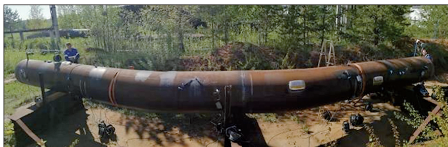
Рис. 1. Внешний вид стенда № 1, подготовленного для проведения испытаний (панорамный режим фотосъемки привел к визуальному искажению прямолинейных труб на снимке)
