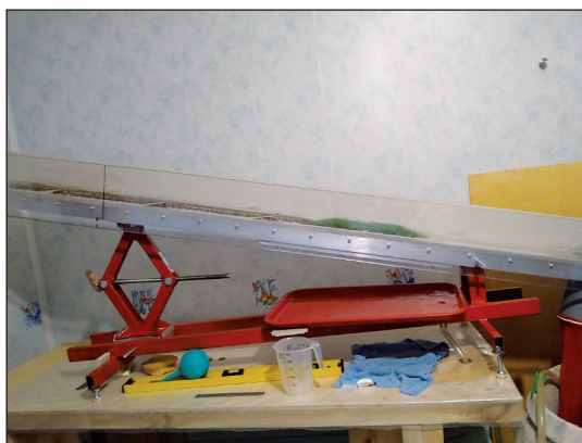
Рис. 3. Гидравлическая установка для исследования противоэрозионной стойкости
