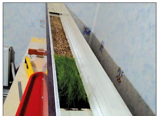
Рис. 4. Исследуемый образец с проросшей травой на гидравлической установке
