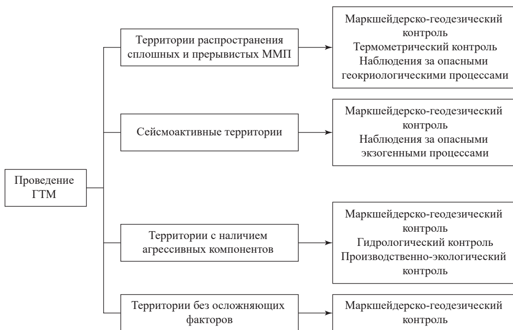
Рис. 1. Типы производственных работ ГТМ на территориях освоения с различными осложняющими факторами (по результатам анализа опросных листов)
