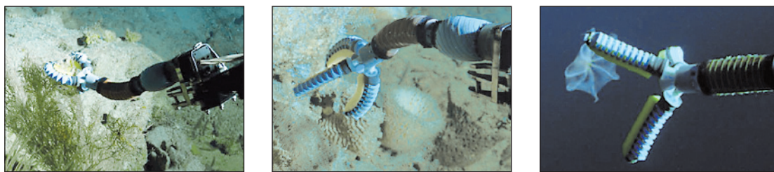
Рис. 2. Выполнение работ гибким манипулятором в районе архипелага Фернанду-ди-Норонья (Бразилия)
