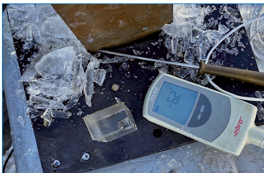
Рис. 5. Фрагменты льда, образовавшиеся во время испытаний на сжатие льда, и образец льда перед испытанием
