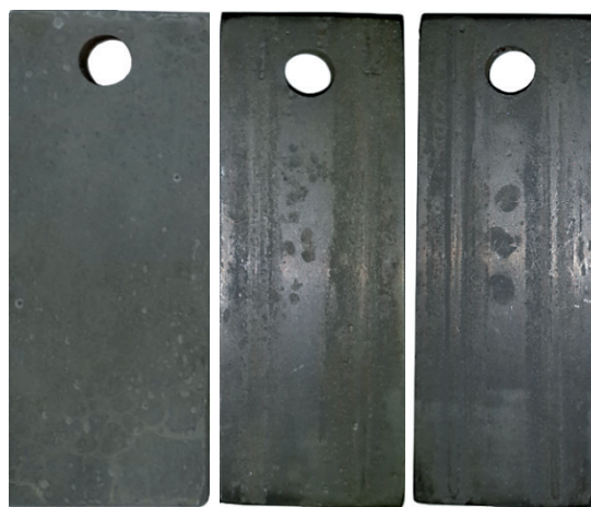
Рис. 1. Вид стальных образцов после испытаний в условиях конденсации влаги (вода:МЭГ) в присутствии \text{CO}_2
