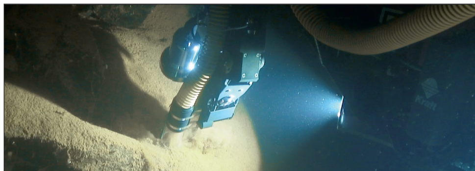
Рис. 1. Выполнение ТНПА Neried работ по забору фракций грунта
