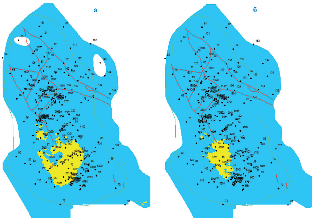
Рис. 8. Схемы интегрального характера насыщения коллекторов залежей ТП 3 (а), ТП 4 (б) Бованенковского НГКМ, по данным геологической модели подсчета запасов 2021 г.: см. экспликацию к рис. 7
