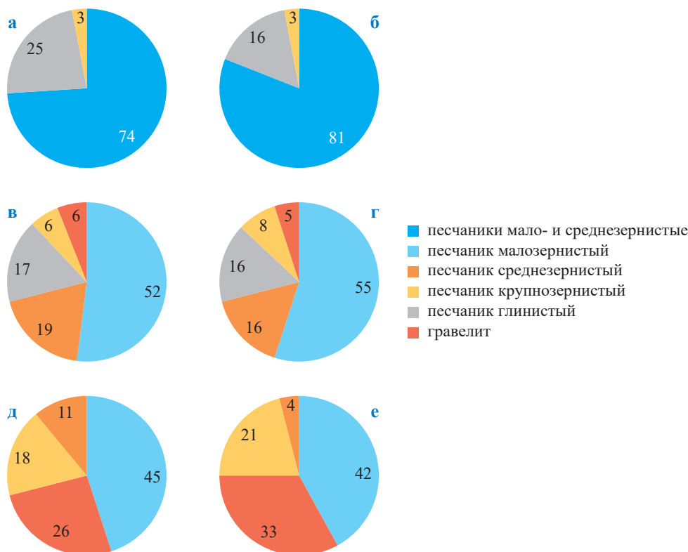
Рис. 4. Процентные соотношения литотипов по данным описания керна (а, в, д), сопоставленные с результатами выделения литотипов по ГИС (б, г, е) для коллекторов ботубинского (а, б), хамакинского (в, г) и талахского (д, е) горизонтов ЧНГКМ
