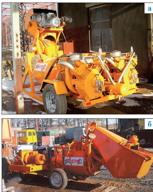
Рис. 6. Механизированный комплекс в системе «Экобетон»: а – вид спереди; б – вид сзади
