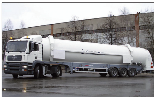
Рис. 2. Автотранспортная цистерна жидкого водорода объемом 45 м 3
