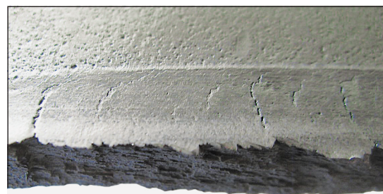
Рис. 4. Характер разрушения вследствие МП
