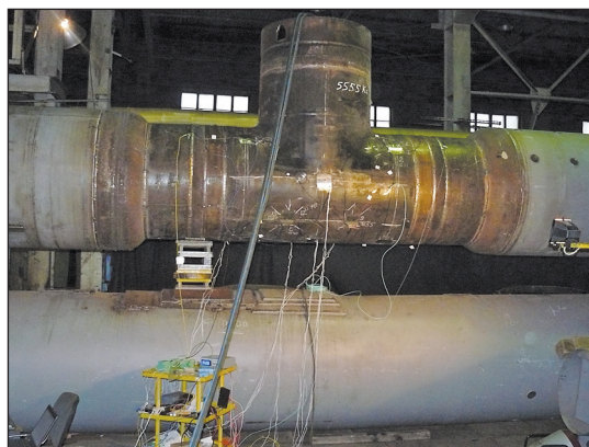
Рис. 4. ИЭ (тройник) в составе испытательного стенда
