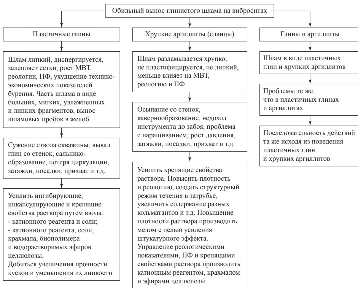
Рис. 6. Алгоритм управления свойствами поликатионного раствора при бурении глинисто-аргиллитовых пород на основе анализа шлама на виброситах
