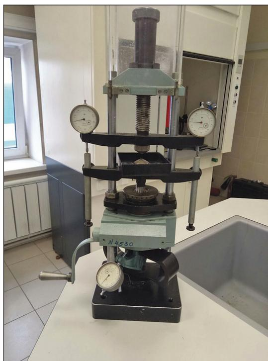
**Рис. 1. Прибор-пробник ИСМ 190 «Викинг» для определения механических показателей пород при раскалывании сферическими инденторами**
