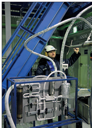
Рис. 5. Устройство для определения уноса капельной жидкости с газом сепарации
