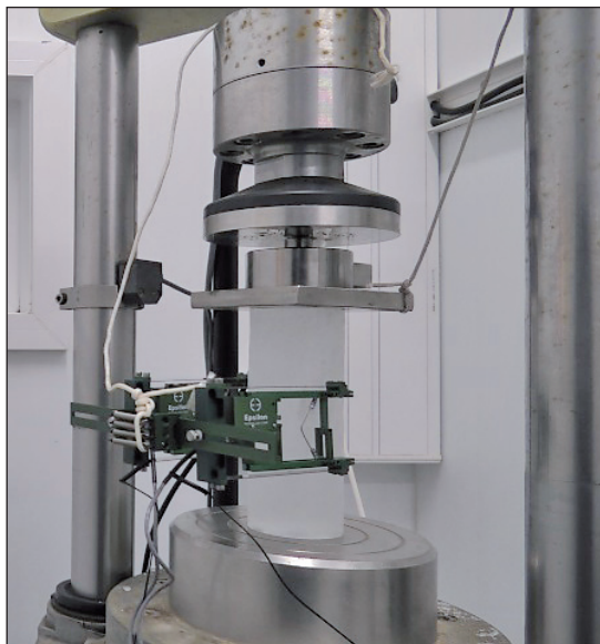
Рис. 1. Керн льда в прессе для одноосевого сжатия. Датчик силы установлен на керне. Датчик деформаций прикреплен в средней части керна
