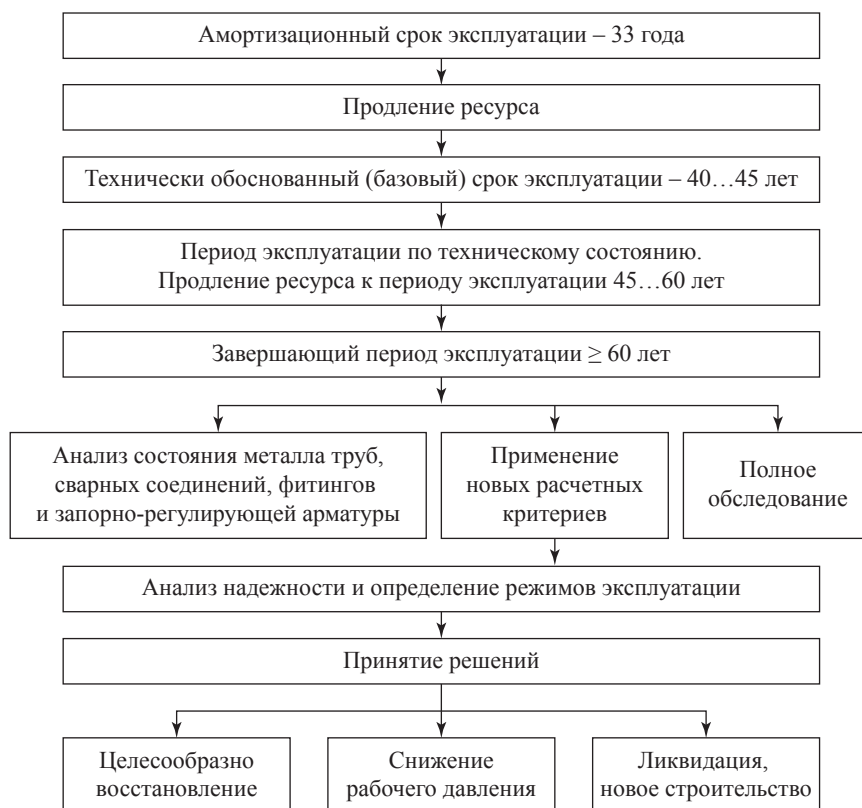
Рис. 7. Укрупненный алгоритм оценки сроков безопасной эксплуатации МГ
