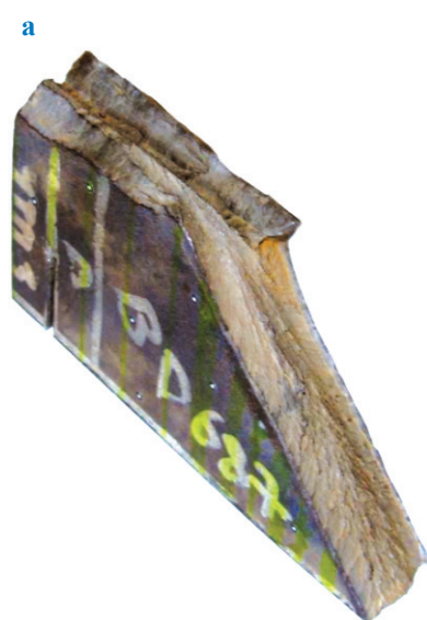
Рис. 10. Фрагмент трубы с изломом типа «шеvron»: а – участок излома (фото); б – вертикальные 3D-сечения с замером толщины
