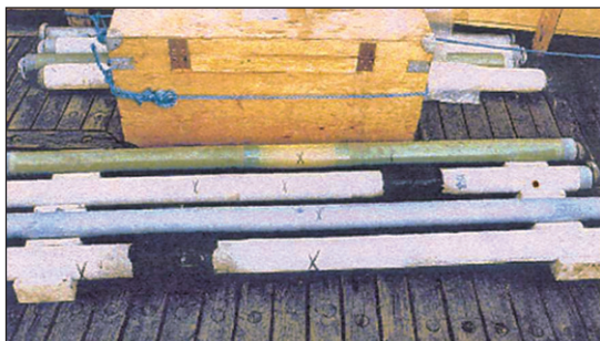
Рис. 10. Натурные испытания элементов труб в Черном море. Турецкий склон. Глубина 300 м. Образцы труб с покрытиями
