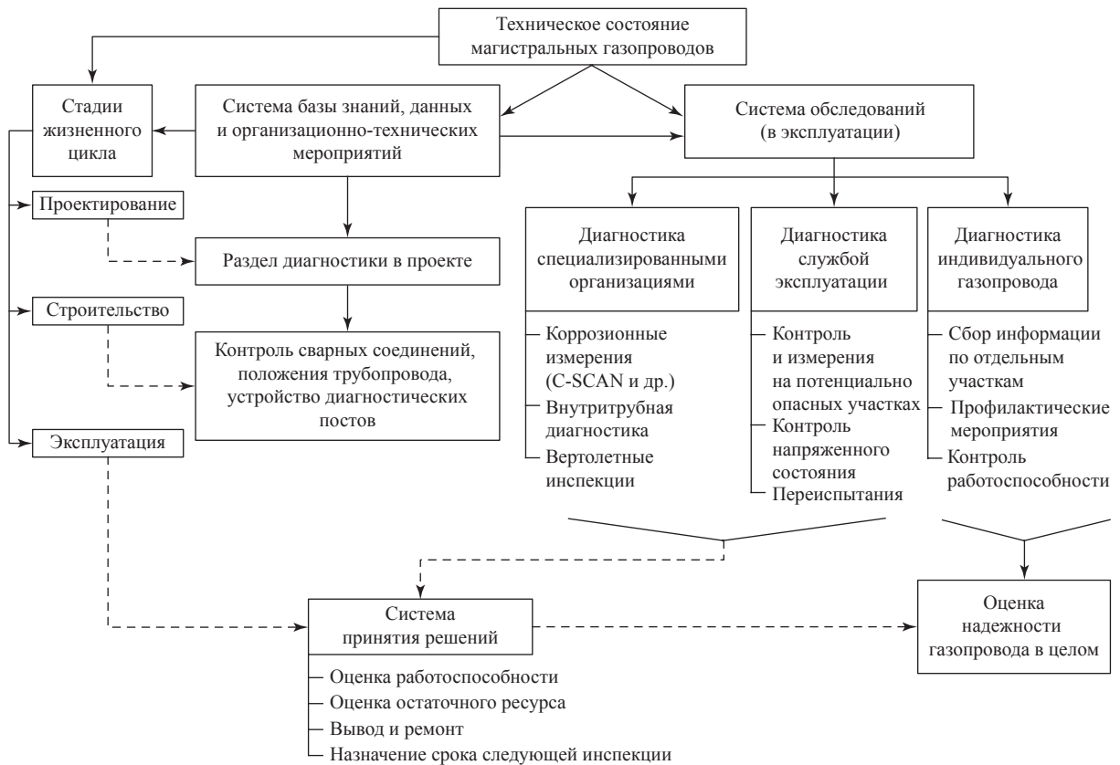
Рис. 2. Принципиальная схема анализа технического состояния газопроводов
