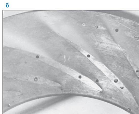
Рис. 6. Структура потока в ЛД: а – по CFD-расчету; б – экспериментальная визуализация [13]
