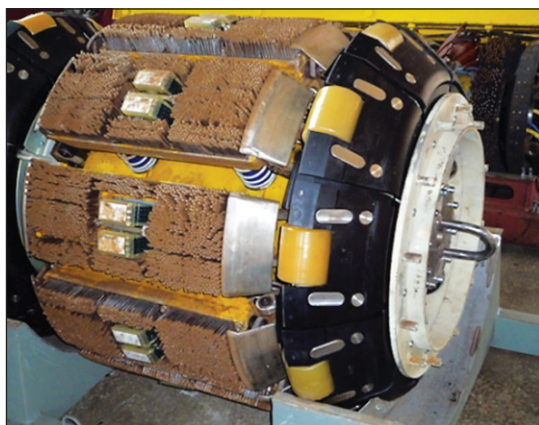
Рис. 5. Магнитный дефектоскоп диаметром 1420 мм с продольным намагничиванием
