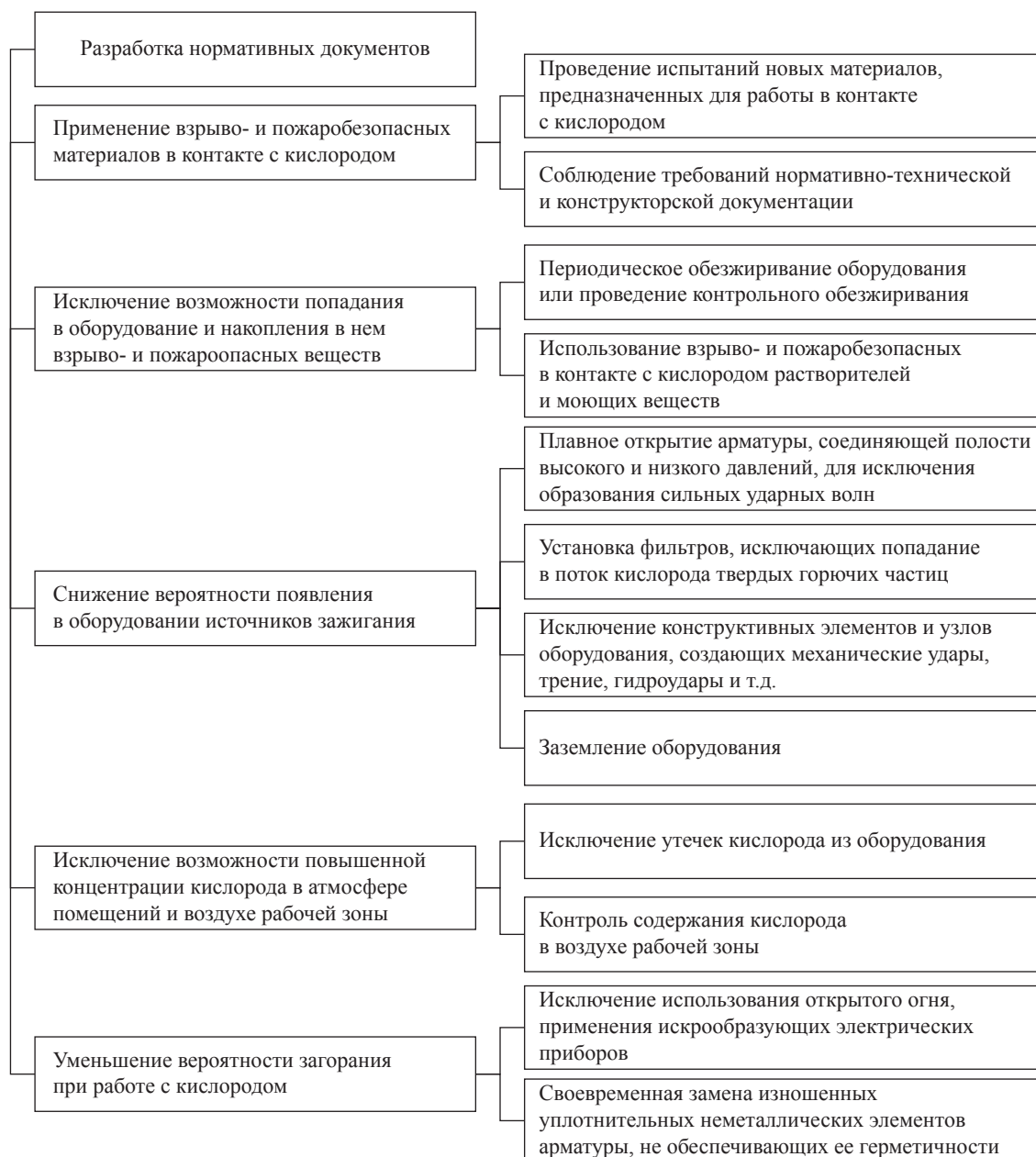
Рис. 3. Меры обеспечения взрывопожаробезопасности кислородного оборудования
