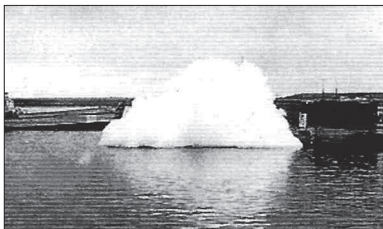
Рис. 3. Сброс жидкого водорода в воду из промышленной системы
