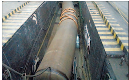
Рис. 5. Разработка технологии изготовления отводов холодного гнутья, в том числе с увеличенным угломгиба, из высокодеформируемых труб российского производства. Исследования упругих характеристик обетонированных труб
