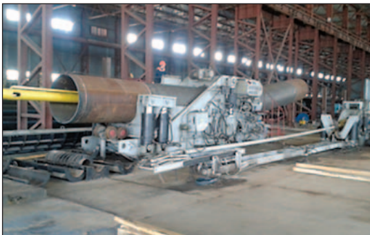
Рис. 5. Разработка технологии изготовления отводов холодного гнутья, в том числе с увеличенным угломгиба, из высокодеформируемых труб российского производства. Исследования упругих характеристик обетонированных труб
