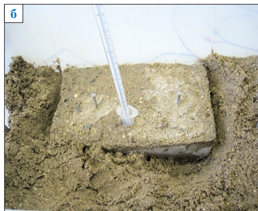
Рис. 1. Общий вид экспериментальной емкости (а) с фрагментом замороженного грунта (б)
