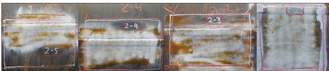
Рис. 1. Примеры отобранных из газопровода образцов, содержащих трещины типа КРН
