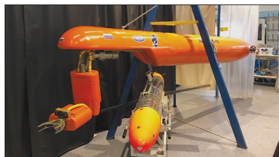
Рис. 8. Демонстратор технологий гибридного интервенционного АНПА и классический глайдер (подводный планер) на опытном производстве АО «НПП ПТ «Океанос»
