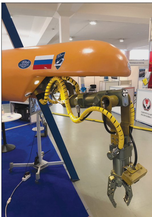
Рис. 9. Подводный электрический манипуляторный комплекс, совместно разработанный СПбГМТУ и АО «НПП ПТ «Океанос»
