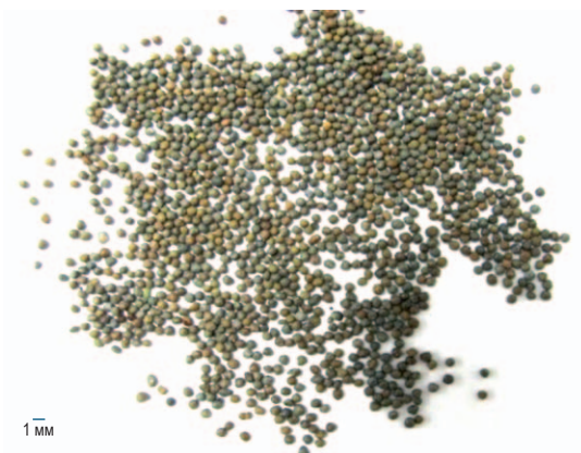
Рис. 18. Калиброванные гранулы, используемые для засыпки в рабочий элемент установки при экспериментальных исследованиях течения газа в пористой среде при высоких скоростях фильтрации
