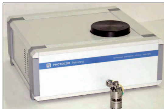
Рис. 2. Принципиальная схема (а) и внешний вид (б) анализатора дисперсных свойств углеводородных систем Photocor Petrotest: на переднем плане фотографии оптическая ячейка высокого давления, применяемая для проведения измерений при пластовых условиях
