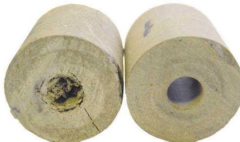
**Рис. 12. Внешний вид образца № 1 с внутренним отверстием до (справа) и после (слева) испытаний при увеличении  $P_{\text{эф}}$**
