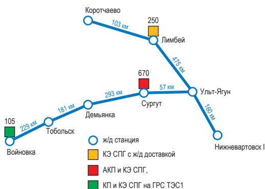
Рис. 8. Вариант 3: производство СПГ на ГРС и автономном комплексе
