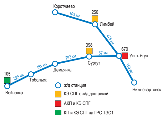
Рис. 7. Вариант 2: производство СПГ на ГРС и автономном комплексе с доставкой на пункты экипировки по железной дороге
