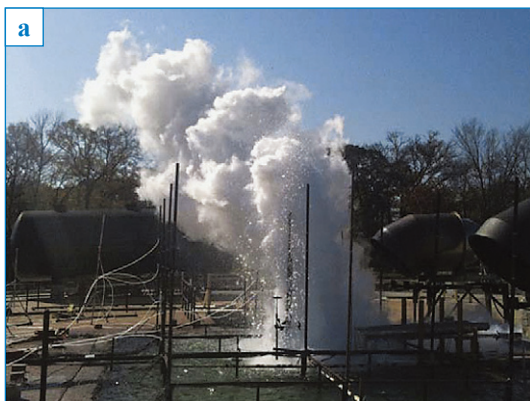
Рис. 7. Вид облака паров СПГ над поверхностью воды при истечении СПГ в толщу воды: а – на большой глубине (теплое газо-воздушное облако быстро всплывает); б – на малой глубине (холодное газо-воздушное облако стелется по земле)
