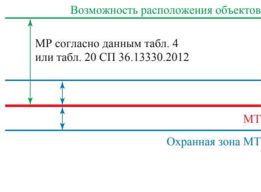
Рис. 2. Условная схема выделения и установления коридоров безопасности
