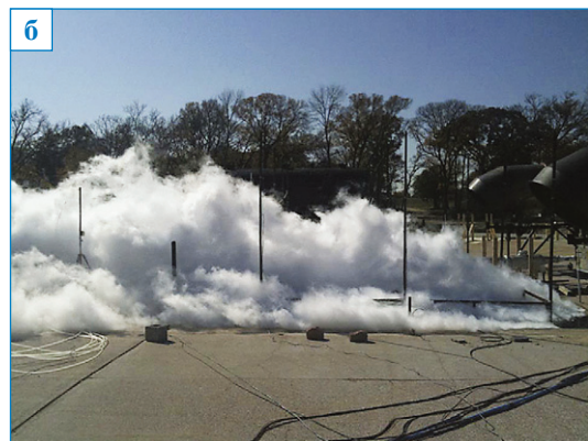
Рис. 7. Вид облака паров СПГ над поверхностью воды при истечении СПГ в толщу воды: а – на большой глубине (теплое газо-воздушное облако быстро всплывает); б – на малой глубине (холодное газо-воздушное облако стелется по земле)
