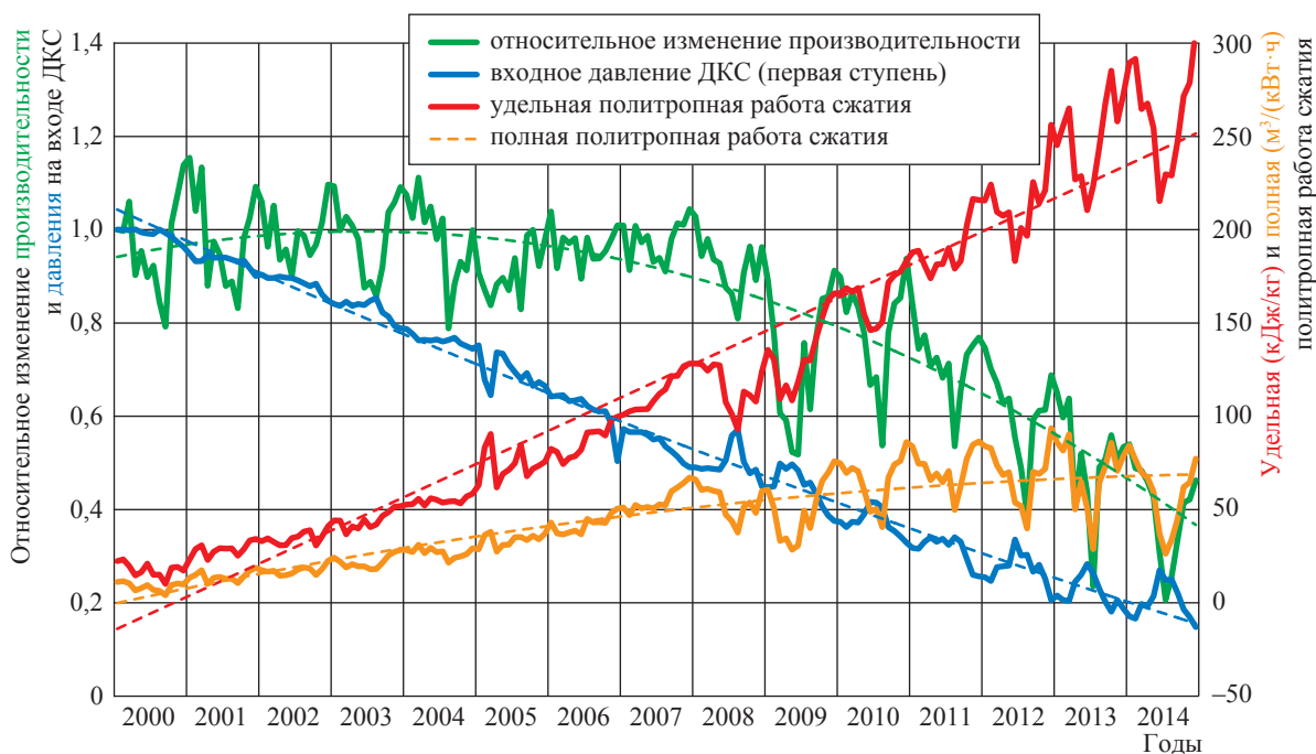
Рис. 3. Графики входного давления, производительности и соответствующих показателей – полной и удельной политропной работ для ДКС Комсомольского ГП
