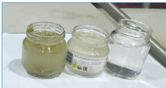
Рис. 5. Образцы отработанного бурового раствора, слева направо: до очистки, после электролизера и на выходе установки
