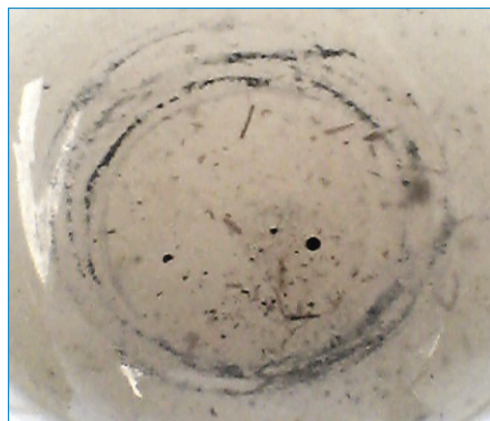
Рис. 1. Агломераты активного ила после 900 ч культивирования
