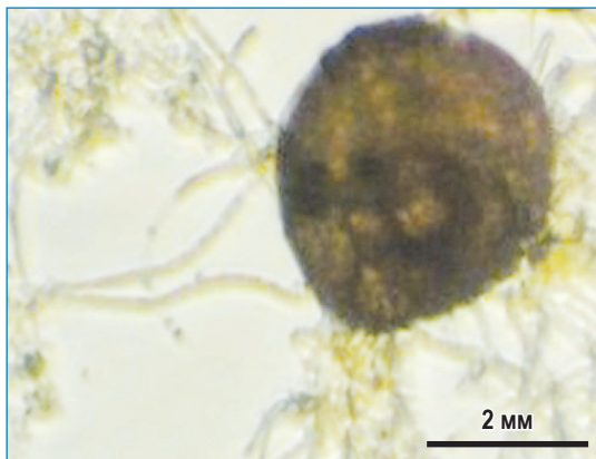
Рис. 5. Гранула аэробного активного ила, стабилизированная воздействием пероксида водорода после изменения субстрата
