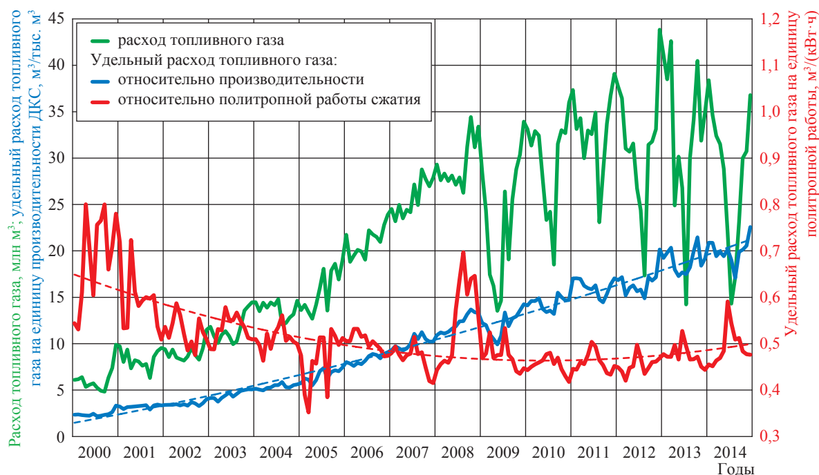
Рис. 4. Графики абсолютных и удельных показателей энергоэффективности процесса компримирования газа на ДКС Комсомольского ГП
