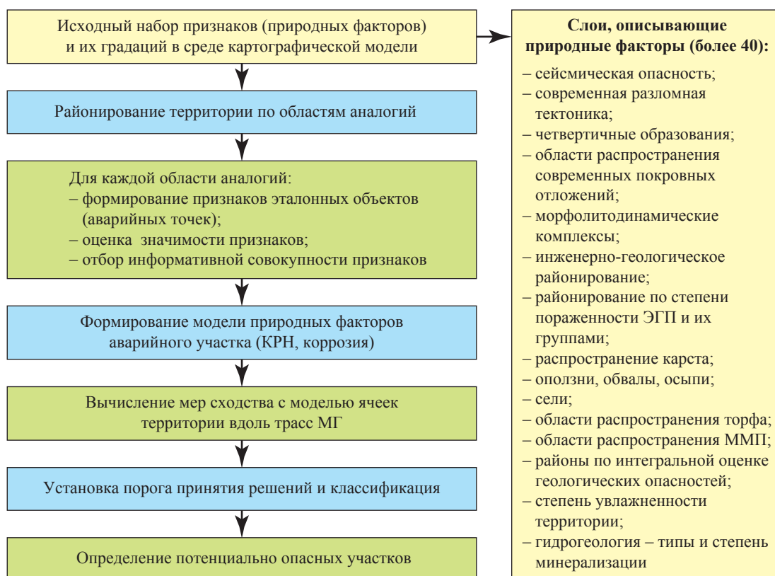
Рис. 5. Алгоритм комплексного анализа природных факторов для выявления потенциальных аварийно опасных участков с использованием метода распознавания образов: ЭГП – экзогенный геологический процесс
