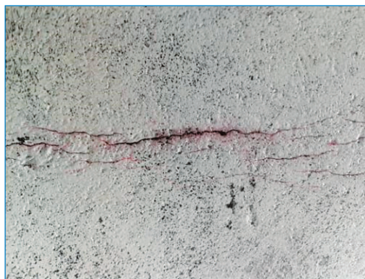
Рис. 1. Общий вид исследованного фрагмента трубы с частично отслоившимся защитным покрытием (а) и стресс-коррозионные повреждения металла, визуализированные с помощью магнитопорошкового метода (б)
