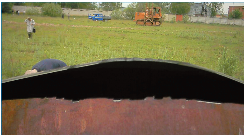
Рис. 8. Разрыв трубы по стресс-коррозионному повреждению при испытаниях на трубопроводном стенде в Серпуховском УМГ ООО «Мострансгаз»: видна рваная линия разрыва трубы, характерная для стресс-коррозионных повреждений
