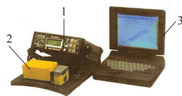
Рис. 4. Многоканальный компьютеризированный вихретоковый дефектоскоп ВД-89НМ для обнаружения и записи оценок размеров стресс-коррозионных трещин: 1 – прибор; 2 – сканер с преобразователями; 3 – ноутбук
