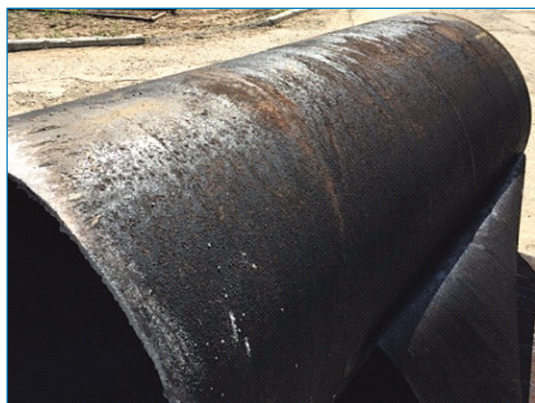
Рис. 1. Общий вид исследованного фрагмента трубы с частично отслоившимся защитным покрытием (а) и стресс-коррозионные повреждения металла, визуализированные с помощью магнитопорошкового метода (б)
