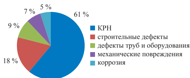
Рис. 1. Распределение причин аварий на МГ ООО «Газпром трансгаз Югорск» за период 2004–2013 гг.
