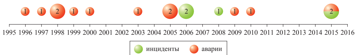
Рис. 1. Количество аварий и инцидентов из-за поперечных стресс-коррозионных трещин в период 1995–2016 гг.
