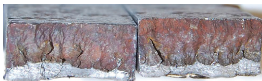
Рис. 12. Поверхность излома образца по трещине КРН из трубы № 1602 газопровода Уренгой – Петровск, к которой после переизоляции поступал грунтовый электролит
