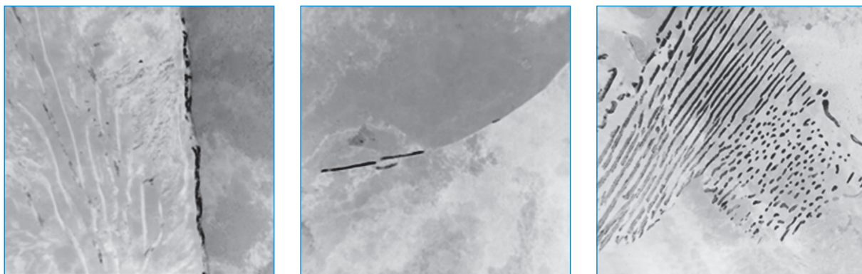
Рис. 6. Электронно-микроскопические изображения выделений цементита в образце 2
