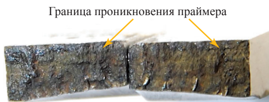
Рис. 13. Поверхность излома образца по трещине КРН, куда после переизоляции участка газопровода грунтовый электролит не поступал
