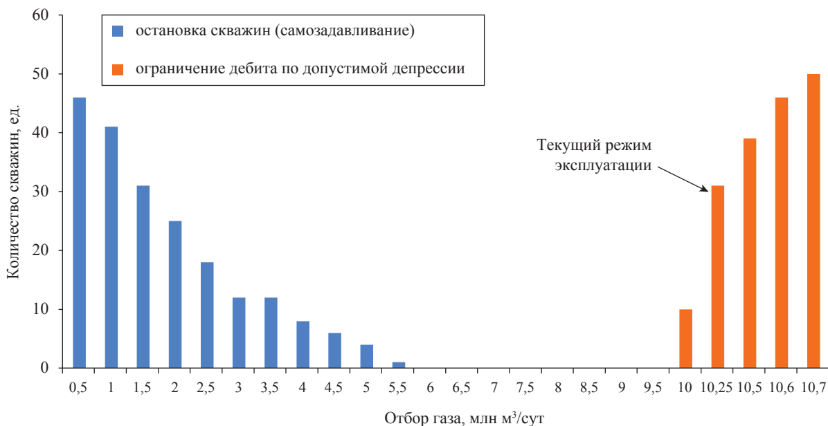
Рис. 3. Особенности эксплуатации фонда скважин при различных уровнях отбора газа по промыслу
